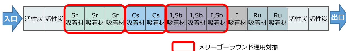
図 II-2 吸着塔構成の例 (2018 年 9 月時点での例)
