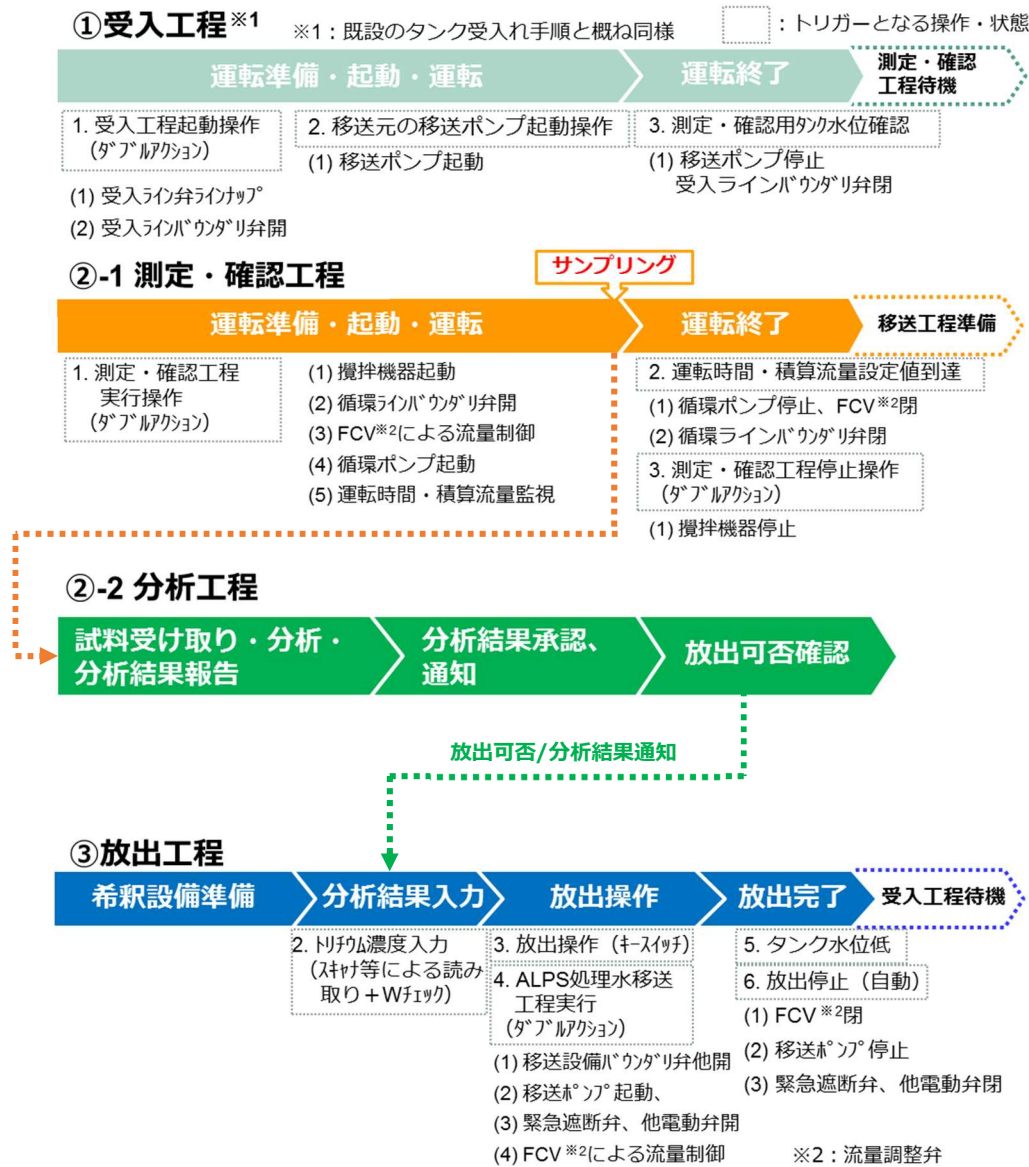
図－3 受入，測定・確認，放出工程の手順
