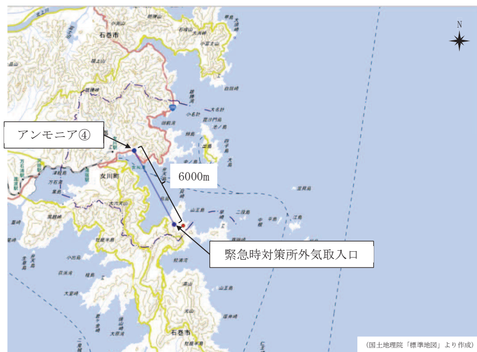
図 14 アンモニア④と緊急時対策所外気取入口との距離の評価結果
