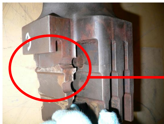
低圧タービン(C) 第14段翼折損状況(119枚目)
