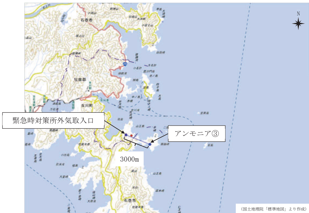
図 13 アンモニア③と緊急時対策所外気取入口との距離の評価結果
