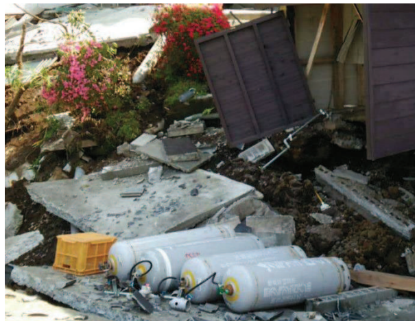
熊本地震でのLPガスボンベの被災状況の一例 3)
