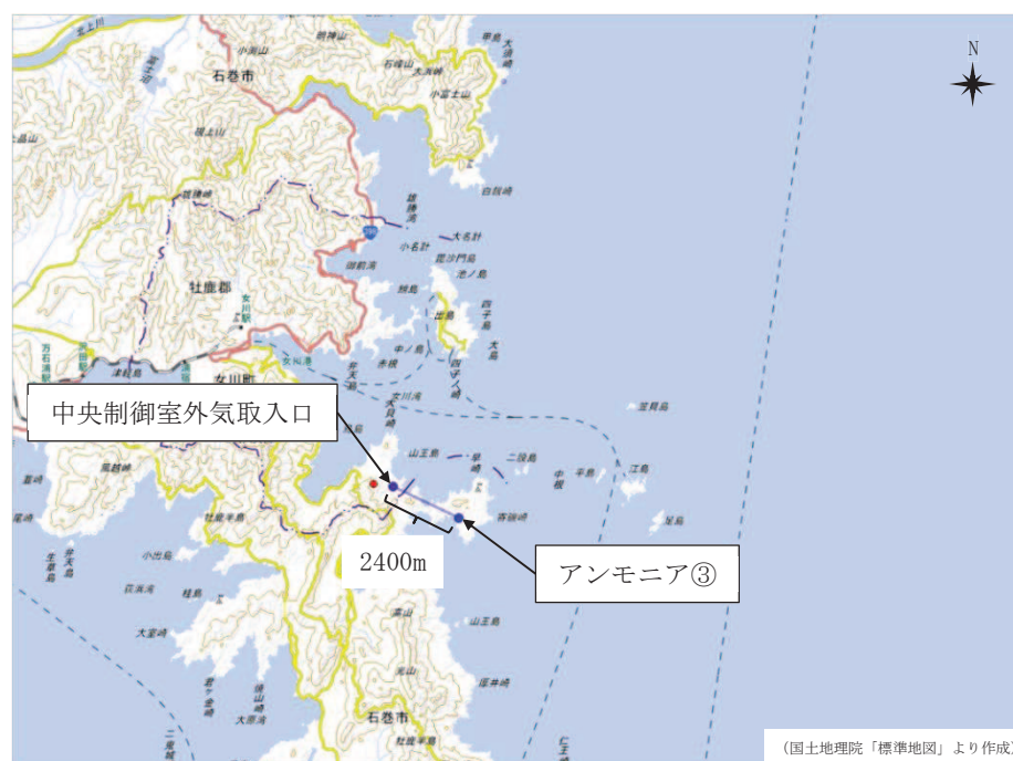
図9 アンモニア③と中央制御室外気取入口との距離の評価結果
