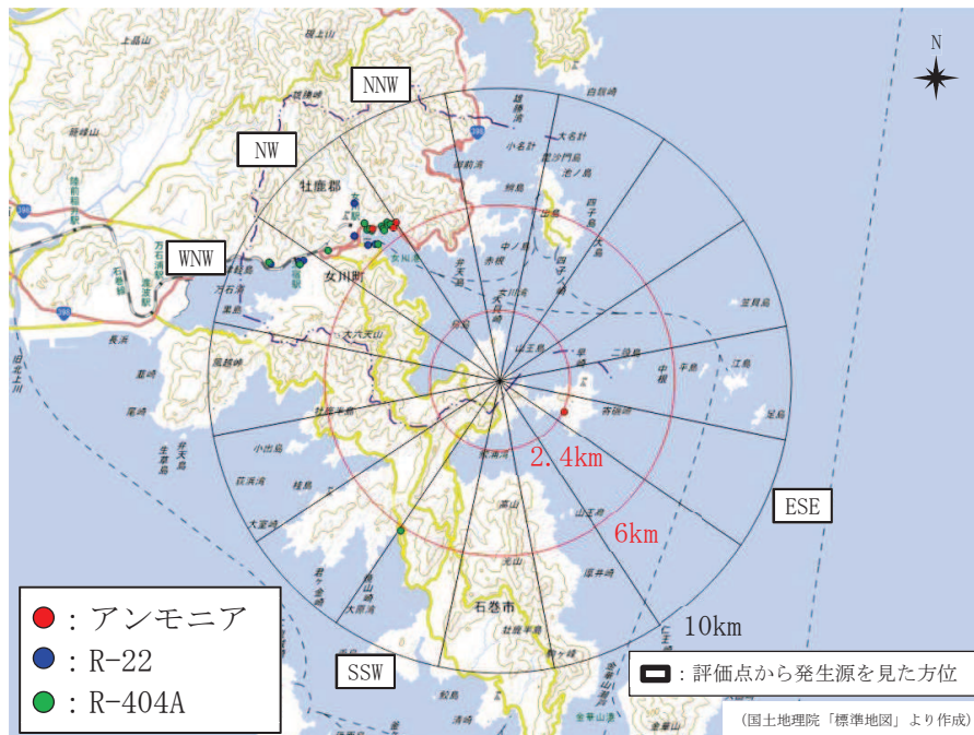
図1 中央制御室と敷地外固定源（高压ガス保安法対象施設）との位置関係
