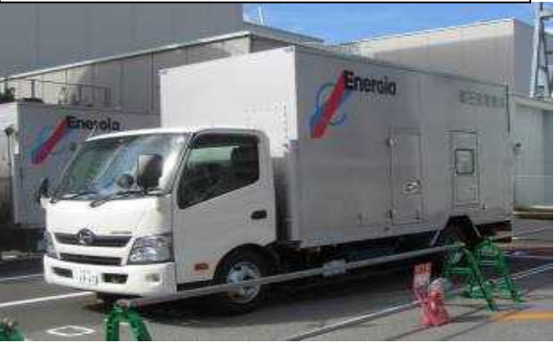
可搬型交流電源設備（高圧発電機車）
