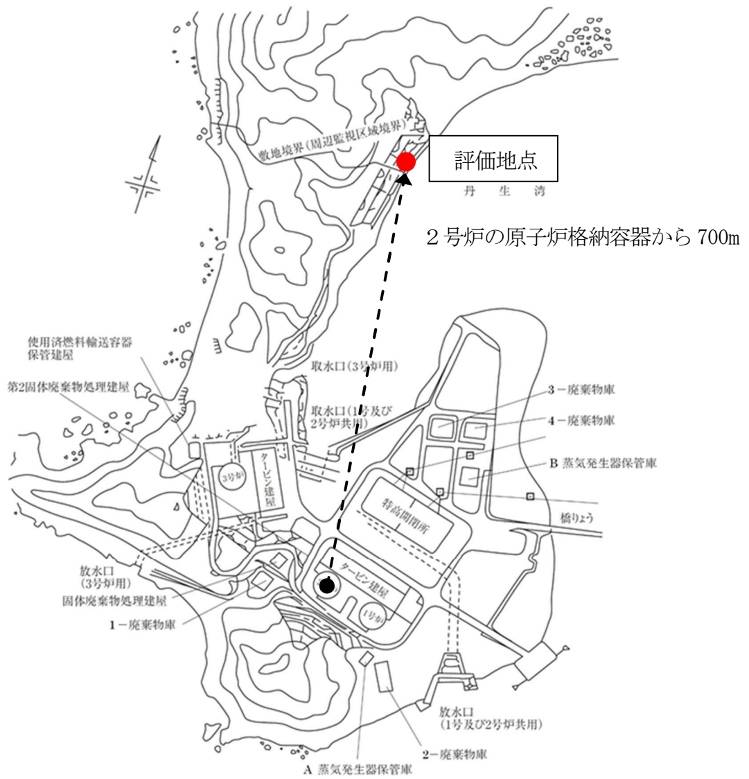
第2図 直接線及びスカイシャイン線の線量評価地点
