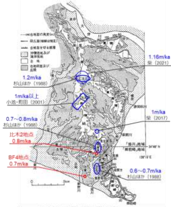
各知見における隆起速度と当社調査による隆起速度（補足説明資料p.39再掲） 杉山ほか (1988) に加筆
