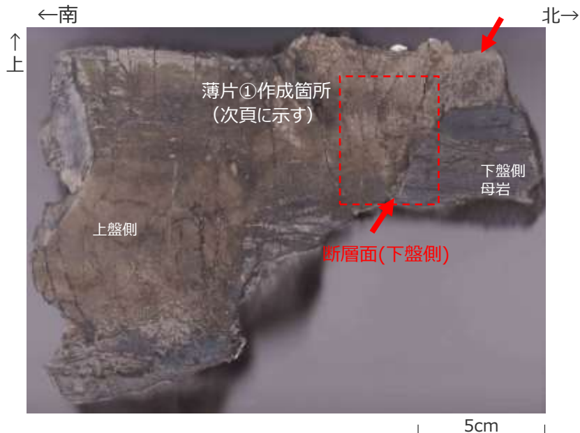
<ブロック試料 (傾斜方向断面)>
