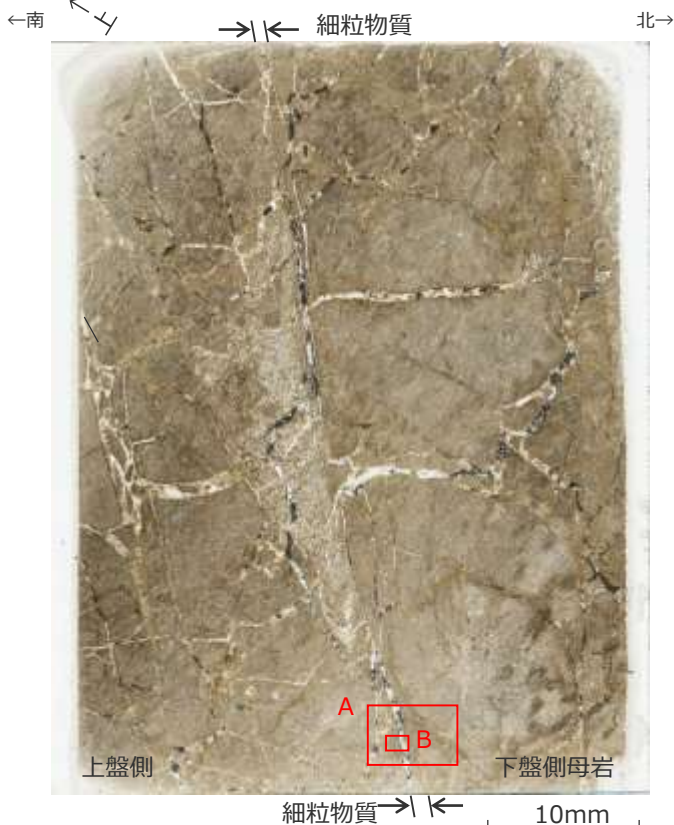
<ブロック試料から作成した薄片写真（単ニコル）>
