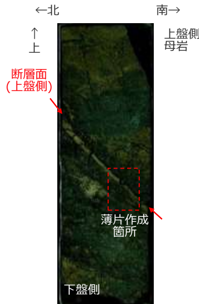
ブロック試料 (傾斜方向断面)
