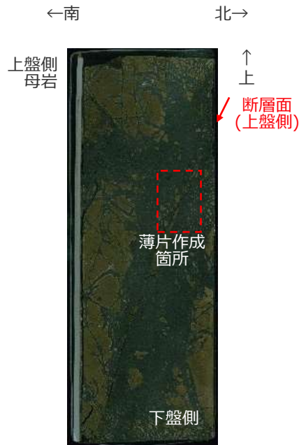
ブロック試料 （傾斜方向断面）
