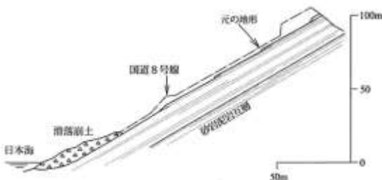
図-3 聖ヶ鼻Aブロック模式断面図
