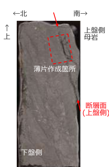
ブロック試料 (傾斜方向断面)
