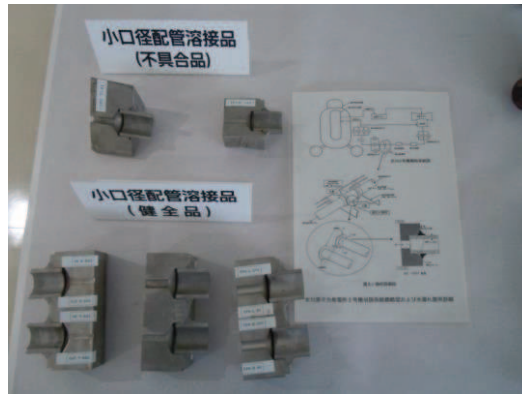
女川 2 号炉 給水流量計からの水漏れ
