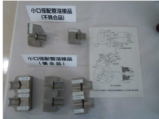
女川 2 号炉 給水流量計からの水漏れ
