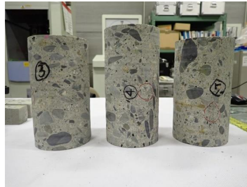
採取されたコンクリートコア
