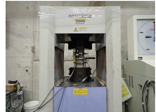
コア供試体の一軸圧縮試験
