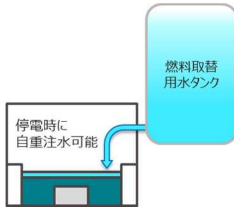
図 12 自重注水による給水イメージ
