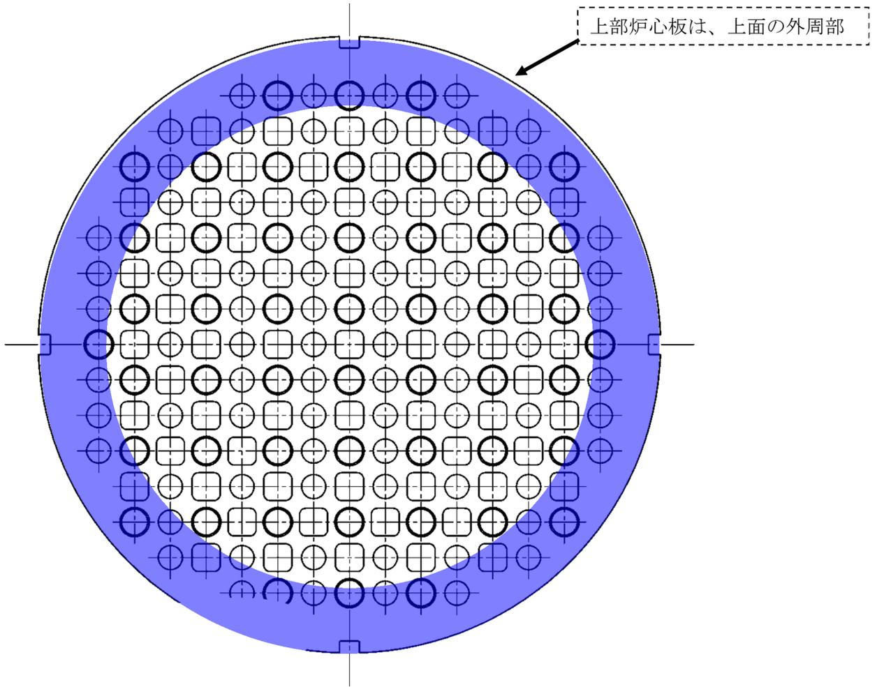
図 4-4 炉内構造物可視範囲概略図（上部炉心板組立図）
