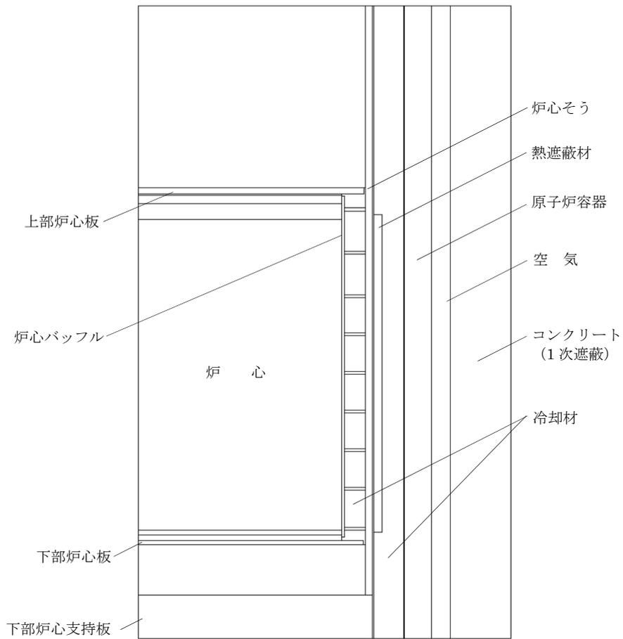
図 3-2 垂直断面形状図 (R、Z 計算)
