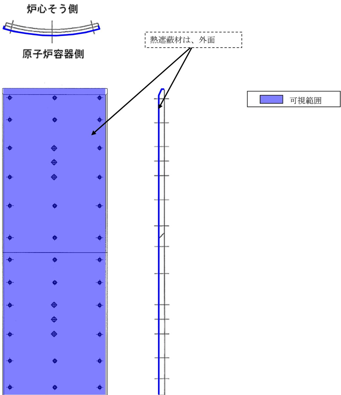
図 4-7 炉内構造物可視範囲概略図 (熱遮蔽材組立図)
