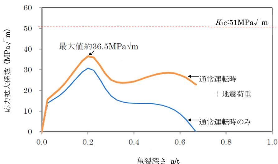
図2 炉心そう溶接部の応力拡大係数と亀裂深さの関係
