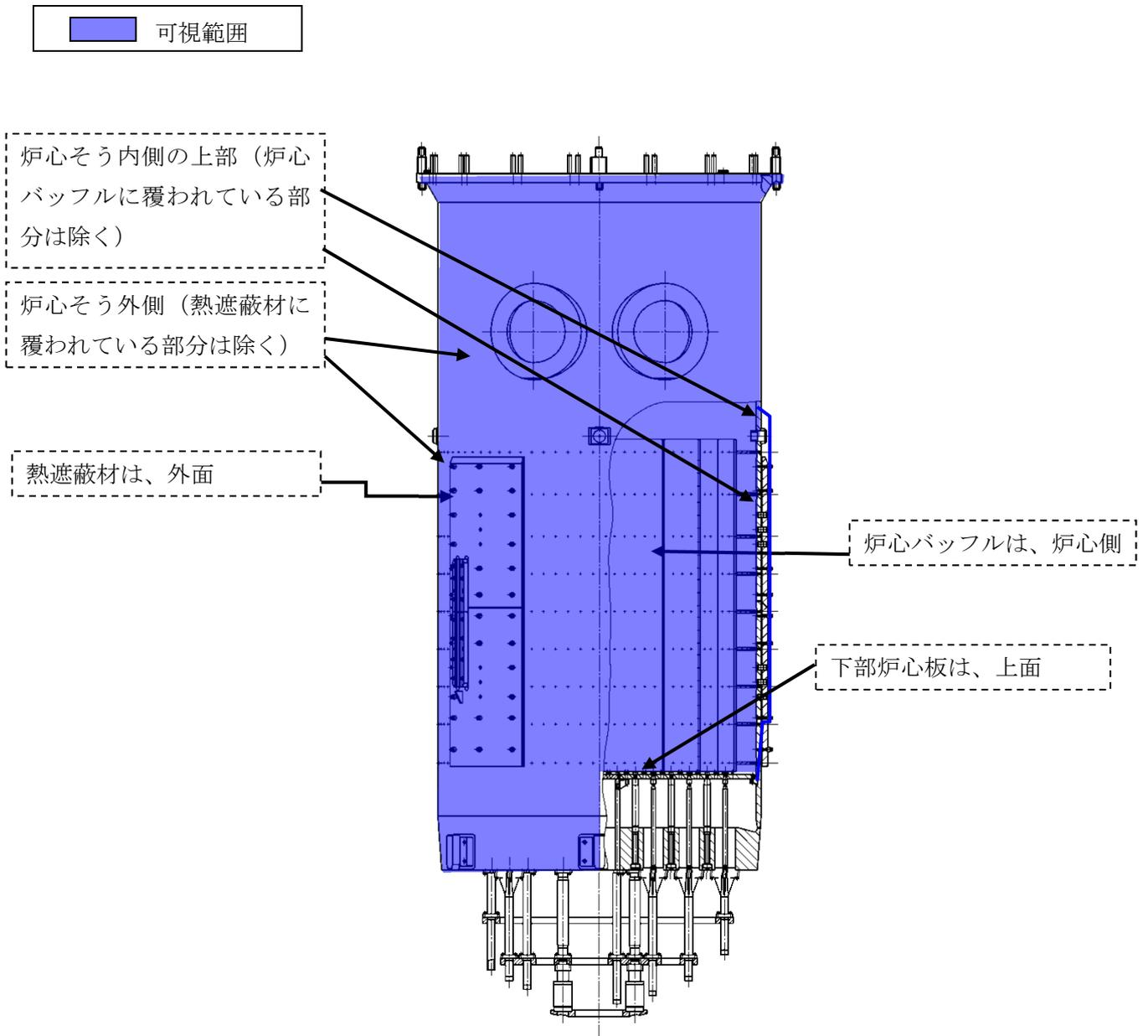
図 4-5 炉内構造物可視範囲概略図（下部炉内構造物構造図）
