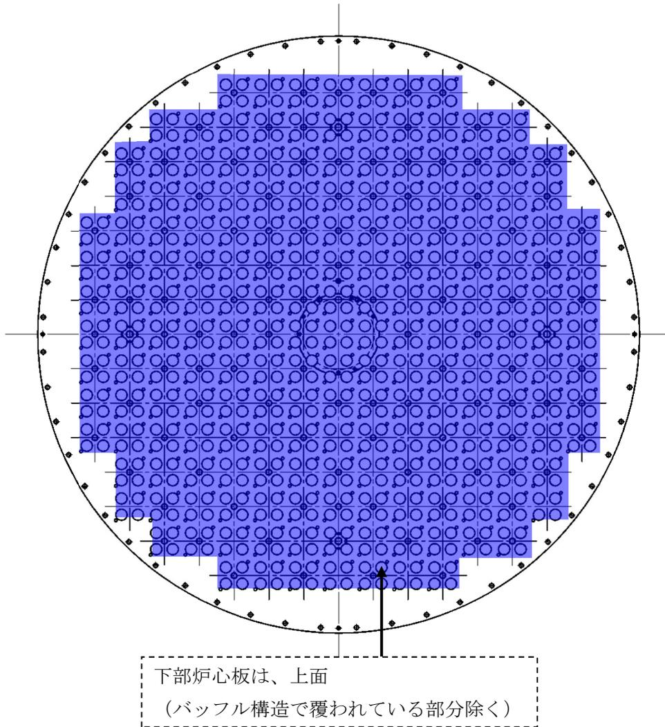
図 4-6 炉内構造物可視範囲概略図 (下部炉心板組立図)
