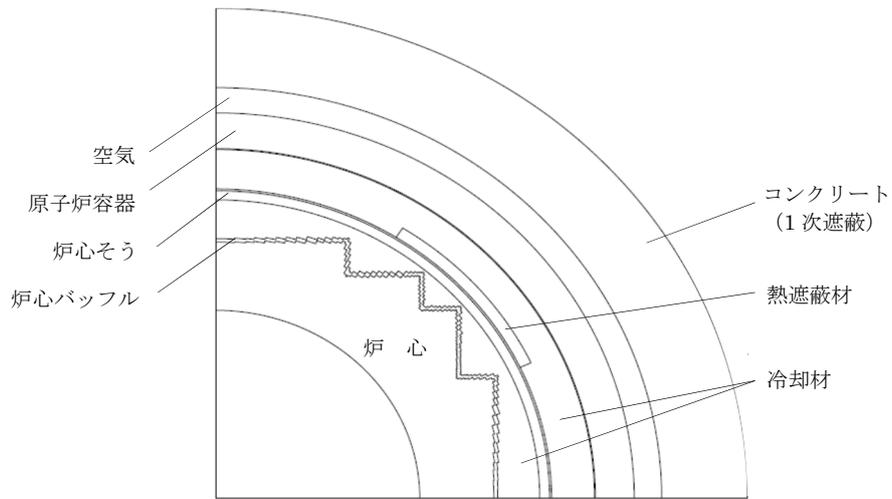
図 3-1 水平断面形状図 (R、 $\theta$  計算)
