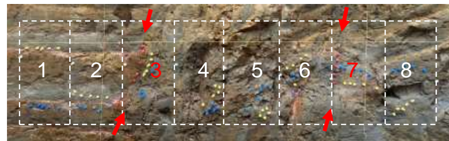
測定面の設定状況 (数字は測定面番号, 赤い数字の測定面は細粒物質を含む測定面を表す。)
