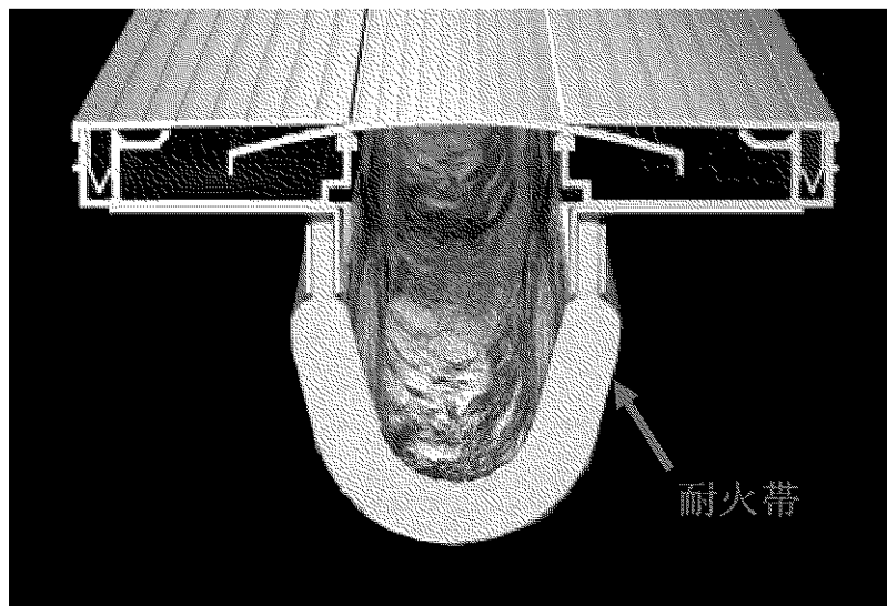
第2図 耐火帯イメージ図（一般建築部に設置される耐火帯）
