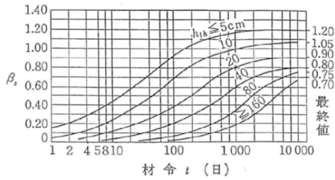
図2 コンクリートの材令 $t$ および部材の仮想厚さ $h_{th}$ に関する関数
