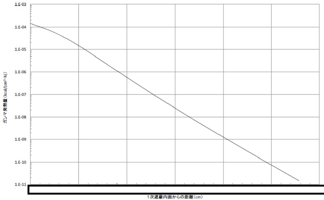
図2 1次遮蔽壁（コンクリート）内のガンマ発熱量分布
