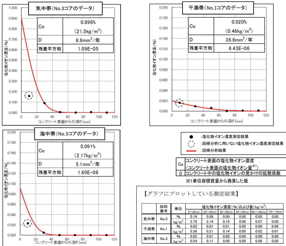
図12-1 拡散方程式の回帰分析結果
