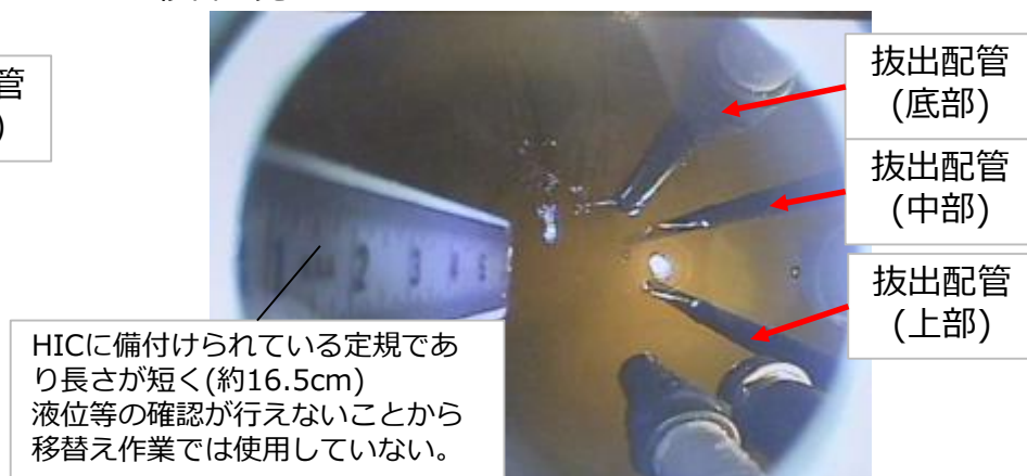
移送完了後の移送先HIC画像
