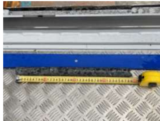
採取されたコンクリート小径コア(例)
