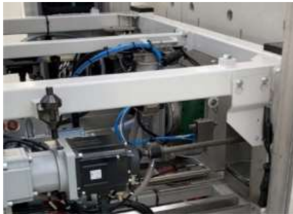
アンカー削孔装置を用いたコア採取
