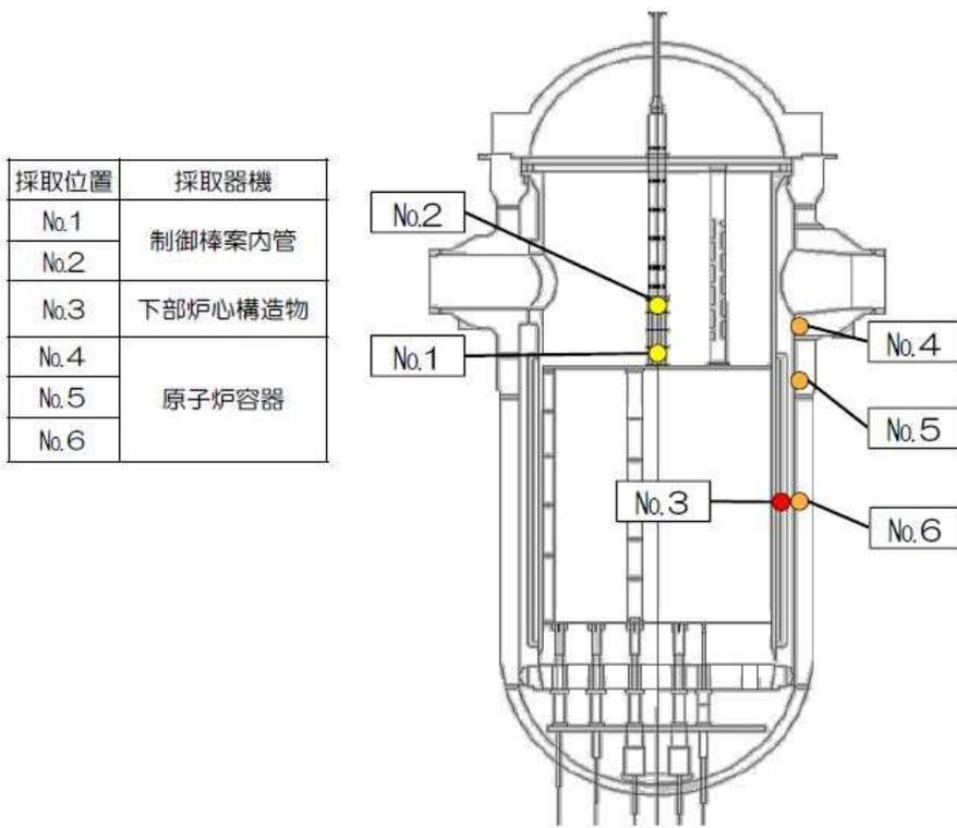
第5図(1/2) 原子炉容器及び炉心支持構造物の代表試料採取箇所（1号炉）
