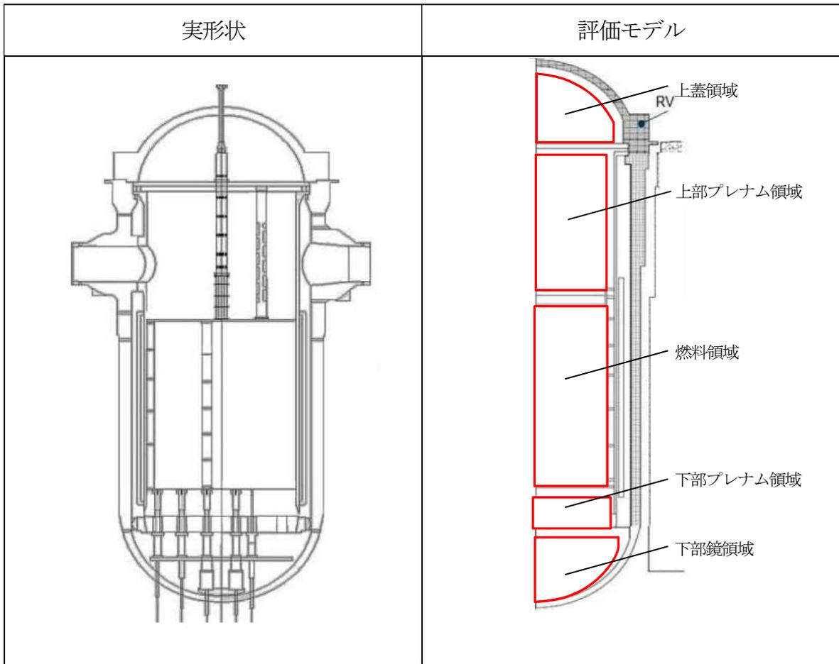
第3図(1/2) 原子炉容器及び炉心支持構造物の評価モデル（軸方向）
