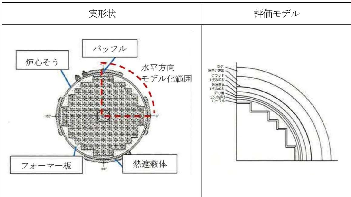
第3図(2/2) 原子炉容器及び炉心支持構造物の評価モデル（水平方向）
