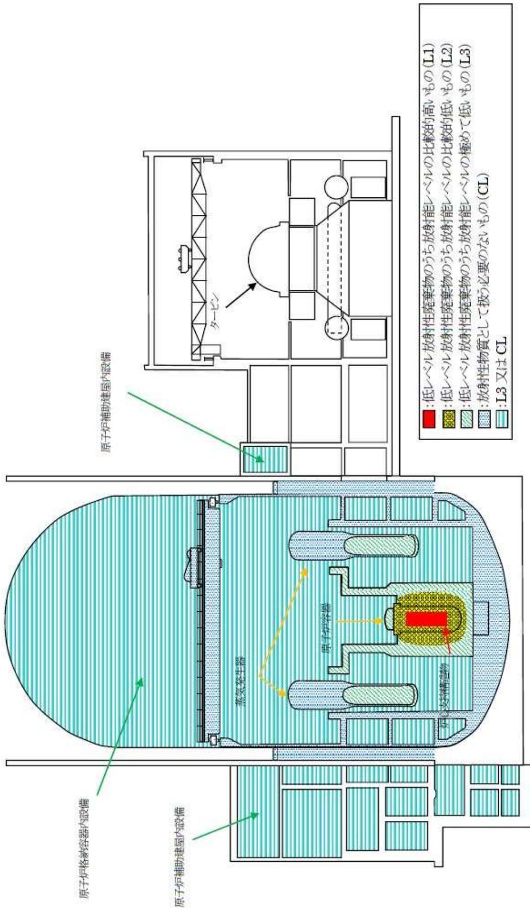
第8図(1/2) 汚染の分布図 (1号炉)
