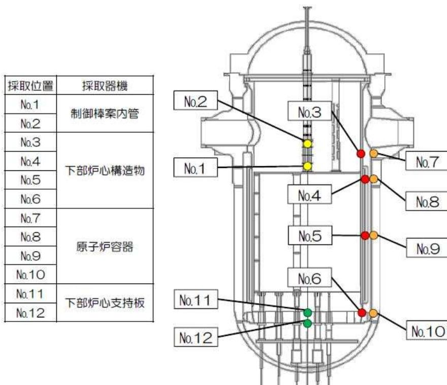
第5図(2/2) 原子炉容器及び炉心支持構造物の代表試料採取箇所（2号炉）
