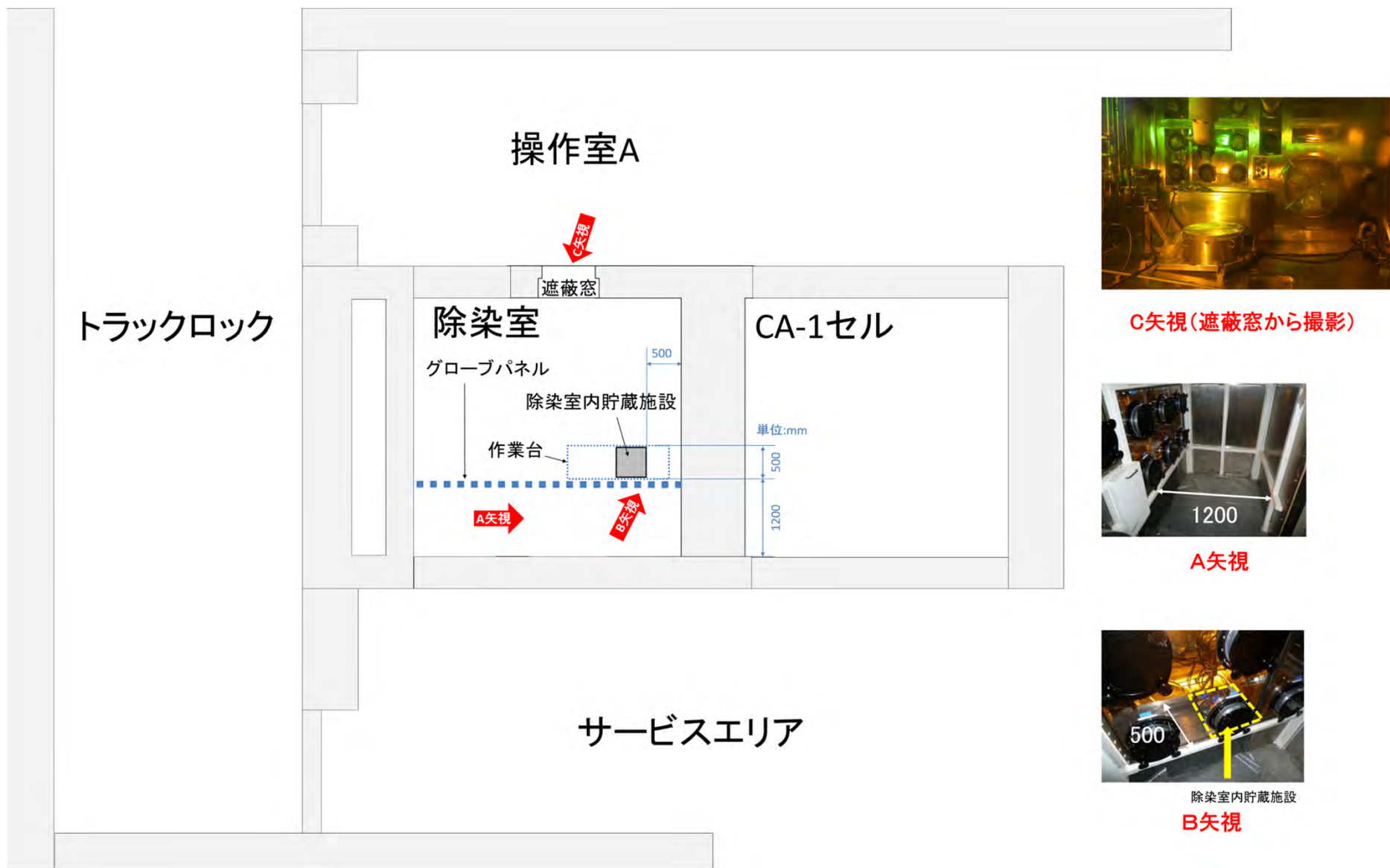
図 3 - 1 除染室内貯蔵施設の位置と外観
