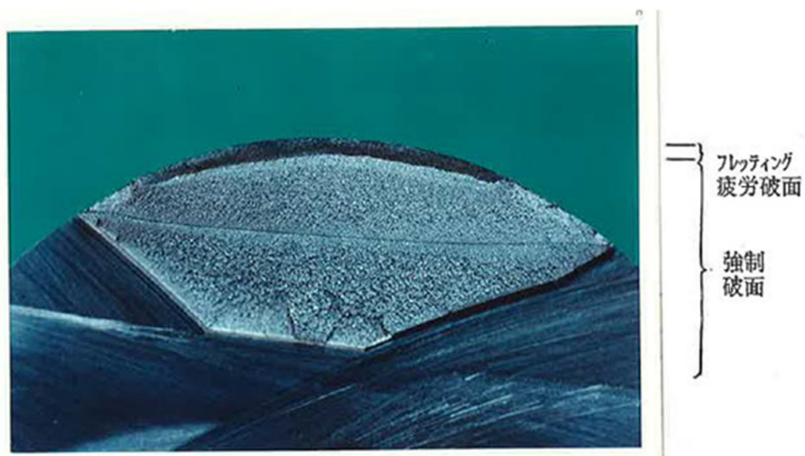
図7 フレット疲労破面例
