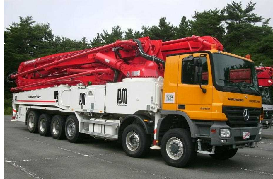
コンクリートポンプ車
