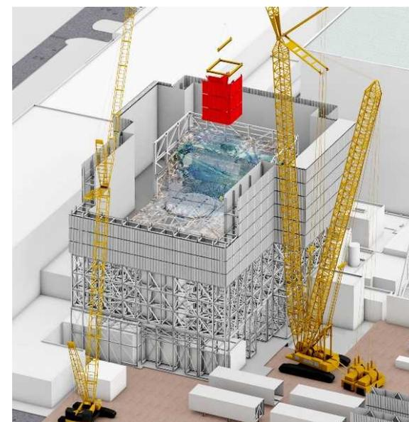
原子炉建屋（高線量エリア）での遠隔操作による鉄骨建方
