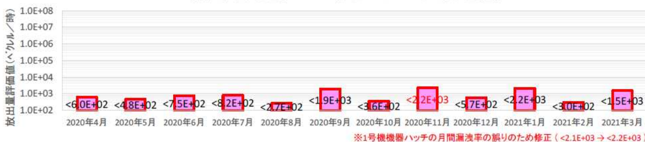
1号機 原子炉建屋、PCVガス管理システムからの放出量推移
