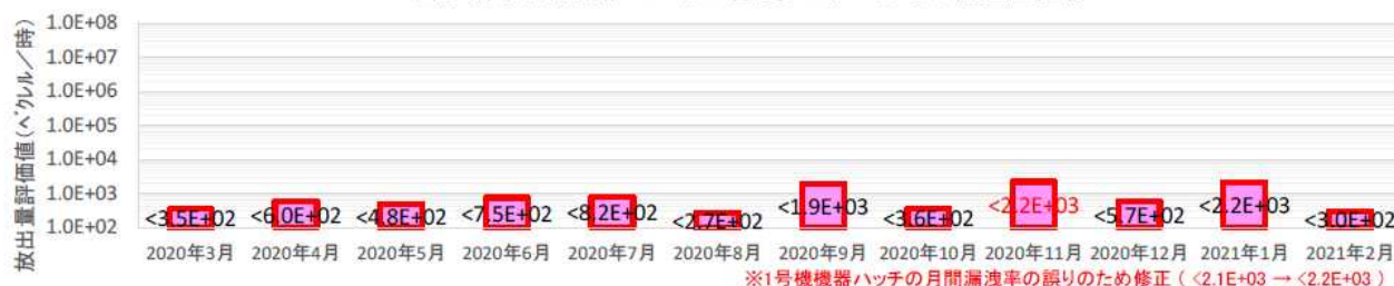
1号機 原子炉建屋、PCVガス管理システムからの放出量推移
