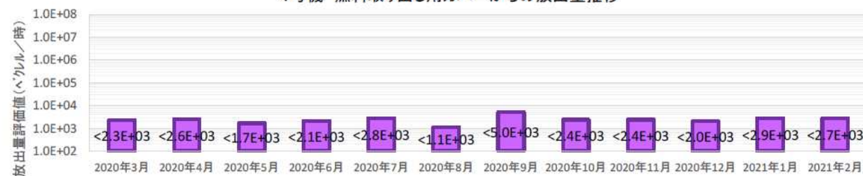
4号機 燃料取り出し用カバーからの放出量推移
