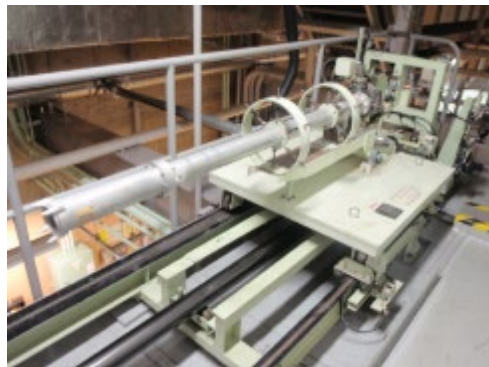
横搬送装置写真
