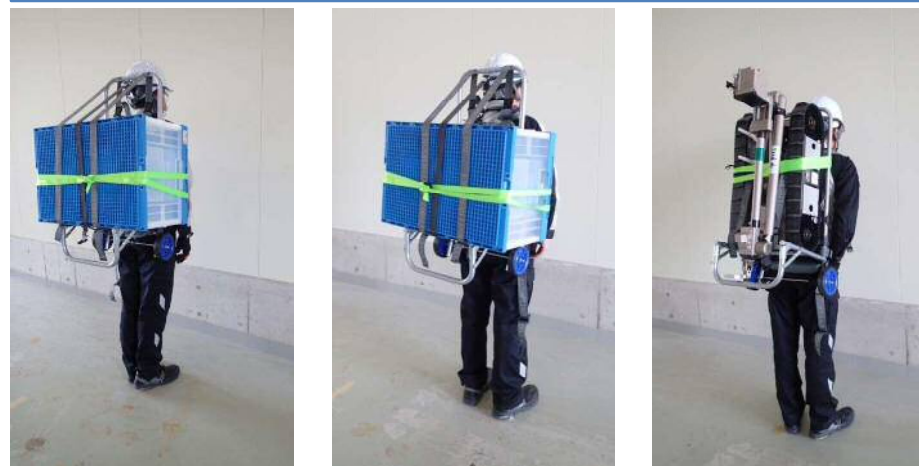
ロボット資機材搬送
