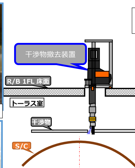
原子炉建屋地下階の干渉物撤去のイメージ図
