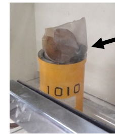
破裂したPVCバッグ
