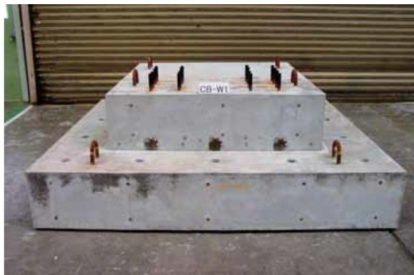
補足-4図 型枠脱型後の試験体
