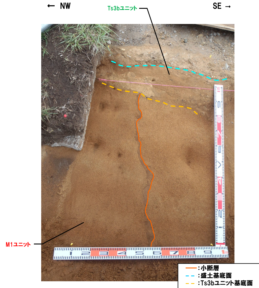
開削調査箇所(南側)海側壁面 小断層上端付近 拡大写真(解釈線あり)
