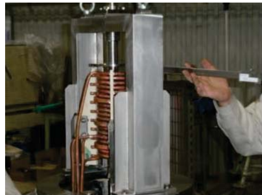
加熱コイルの取付け位置調整の状況
