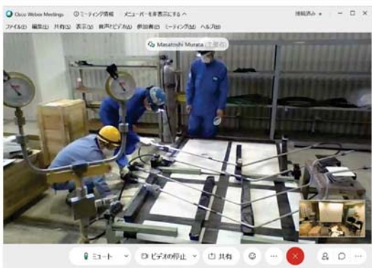
Webによるリモート検査 (圧空配管の耐圧検査の例)
