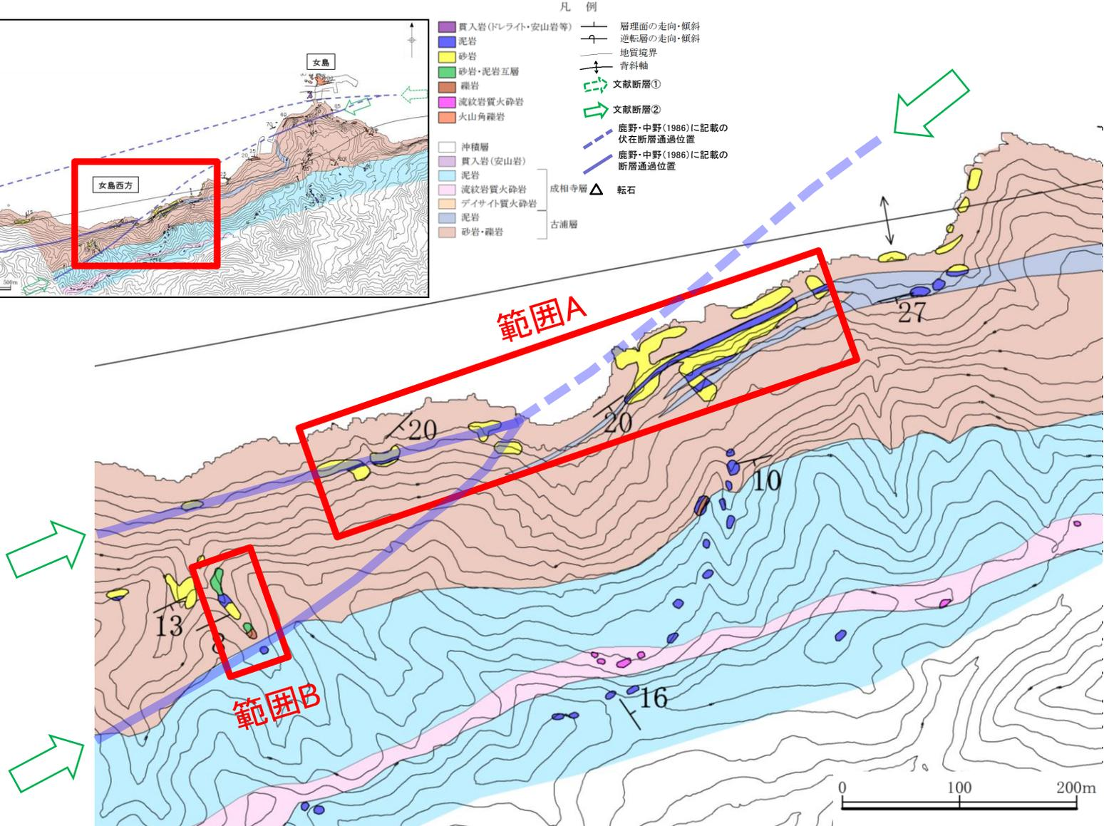
・女島西方の沿岸部の地表地質踏査の結果, 文献断層②の通過位置付近の露頭に断層は認められない。
