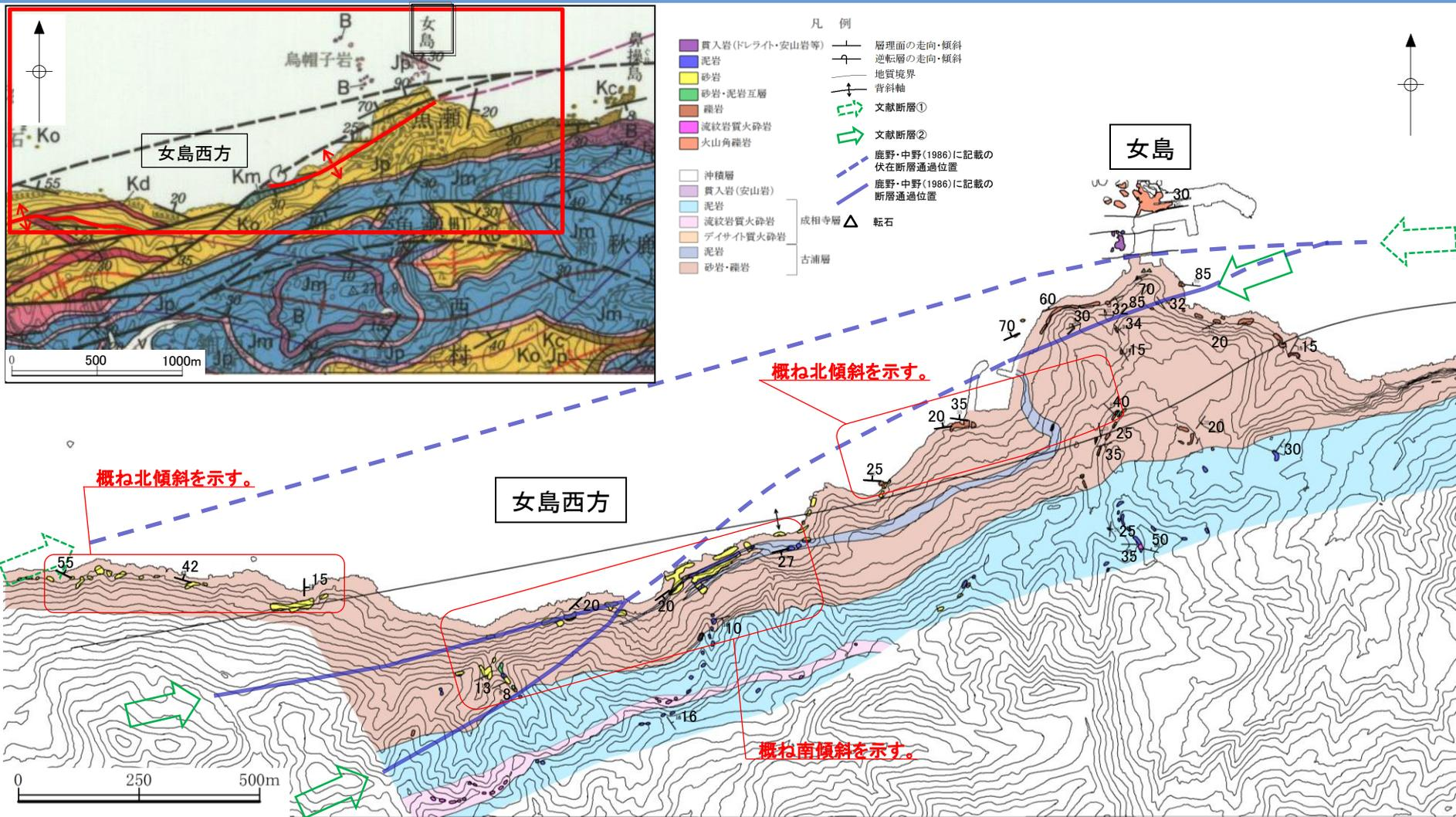
・女島西方の西側では北傾斜の古浦層，女島西方の東側では北傾斜の古浦層が分布することに対し，女島西方の南側では南傾斜の古浦層が分布することから，その間を背斜軸が通過し，女島から女島西方まで連続した構造と考えられる。
