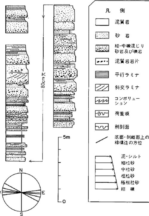
柱状図に示される砂岩の底面・剥離面上にはほぼ縦構造が認められる。その方位を左下隅にまとめて示す
