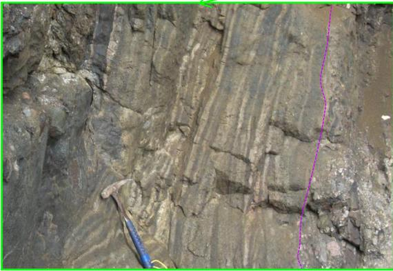
泥岩~凝灰岩の層理面及び礫岩との地層境界は固結、密着している。また、層理面は波打っており、未固結時の変形が認められる。
