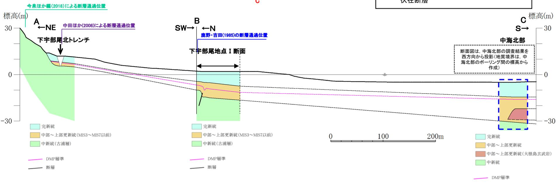
断面図は、中海北部の調査結果を西方向から投影(地質境界は、中海北部のボーリング間の標高から作成)
