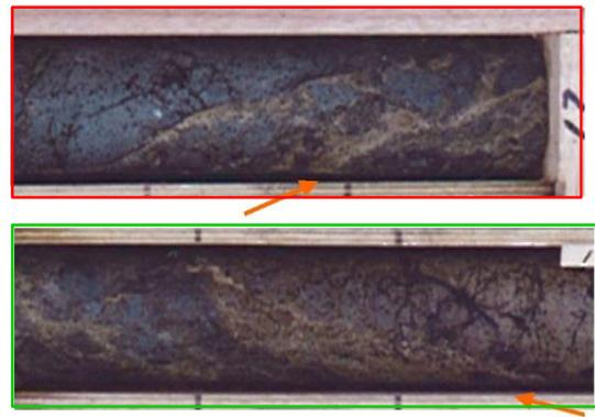
・変質帯内部は、極薄い粘土脈が網目状に発達している。
