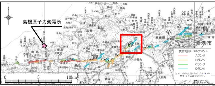
・地表地質踏査の結果, 背斜構造を有する南東側の古浦層及び成相寺層と, 北西傾斜の同斜構造を示す成相寺層との間に断層が推定される。
