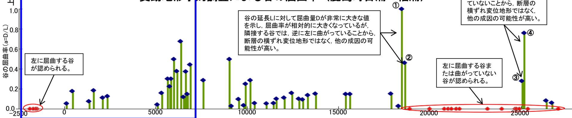
・谷の屈曲量・屈曲率について、西端付近は南講武付近と比較して、次第に小さくなる傾向が認められ、杉山ほか(2005)で示された横ずれ断層の変位量分布のパターン(山型・複合型)と整合的である。
