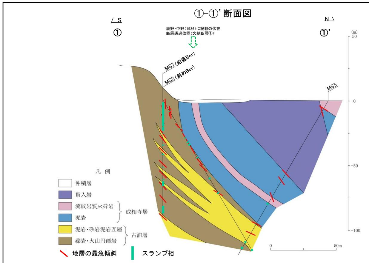
・ボーリング調査の結果, 古浦層には, 偽礫を含む堆積層が複数箇所認められ, また, 一部で堆積構造の乱れやスランプ褶曲が認められる(スランプ相)。これらの堆積構造は, 古浦層中部~上部の地層に対して認められる未固結時の堆積構造(スランプ構造)と考えられ(古川ほか(2008)等), 女島では, 比較的小規模であり連続性に乏しい。
