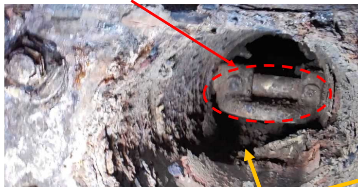
配管内部の状況：錆等の堆積物が確認された。
