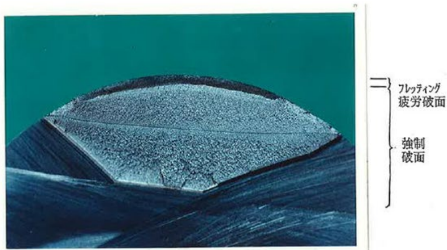
図7 フレット疲労破面例
