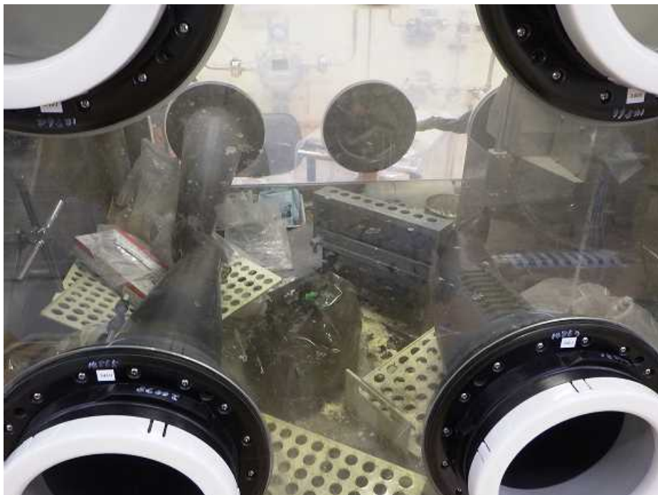
添付図－4 GBL4 内部の状況（中央に焼損した廃棄物容器）
