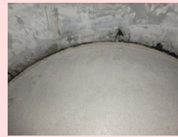
混練後の固化体(翌日硬化確認)
