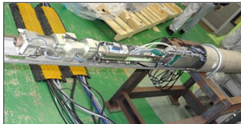
炉内試料採取装置
