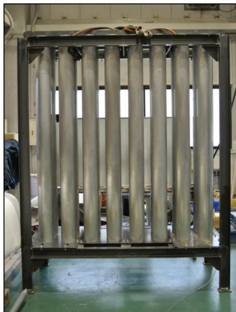
炉内構造物模擬材
