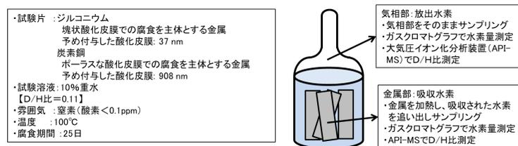
図 2.3-6 腐食試験方法
