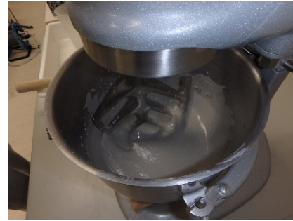
ミキサーによる混練 (4~20分)
