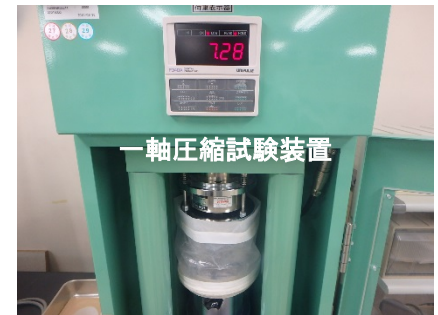
圧縮強度測定 (28日養生後)
