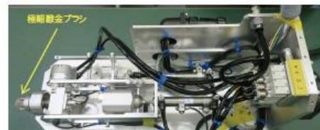
少量回収装置の例(極細線金ブラシ方式)
