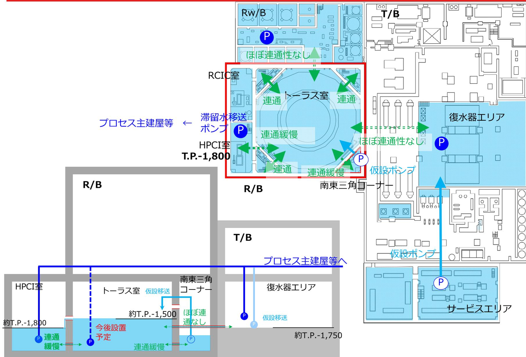
【参考】床ドレンサンプ等への新たなポンプの設置と水位低下工程について
