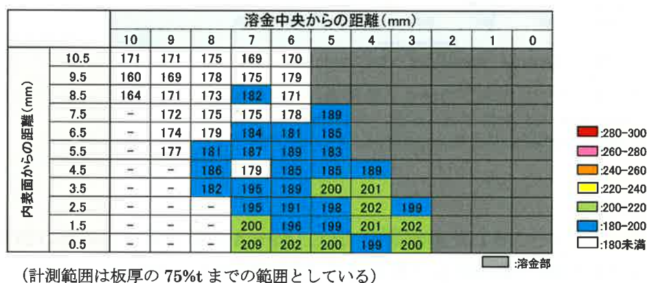
図-5 4B 配管 TIG+SMAW 溶接 板厚内部硬さ測定結果
