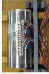
図 3 残留応力測定状況例
