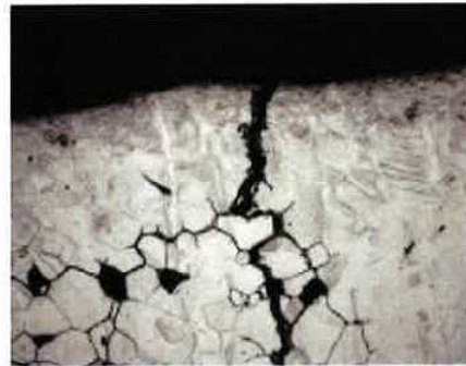
図7 2F-3 シュラウド H6a ポートサンプル断面観察写真
