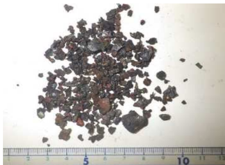
<N 2 バブリング後のSGブローダウン系統の仮設ストレーナ×回収スラッジの拡大図>
