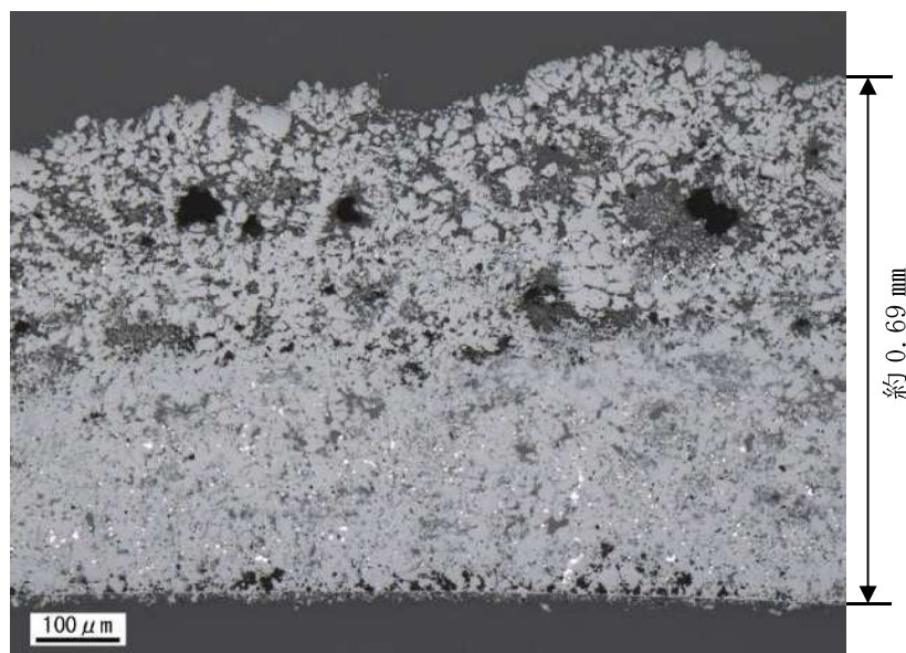
図1 高浜3号機 最上段（第7）管支持板上から採取したスラッジの断面観察例
