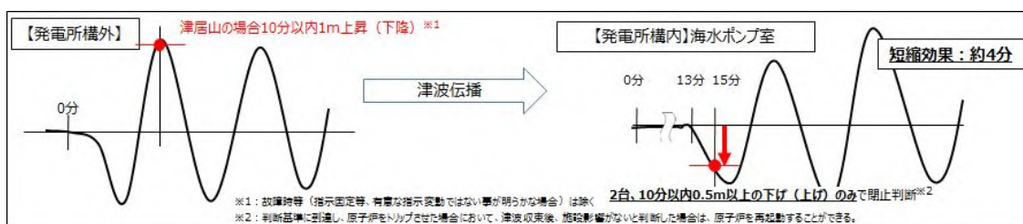
図1 発電所構外にて「プラント影響のある津波」を検知した場合の対応の概念図
