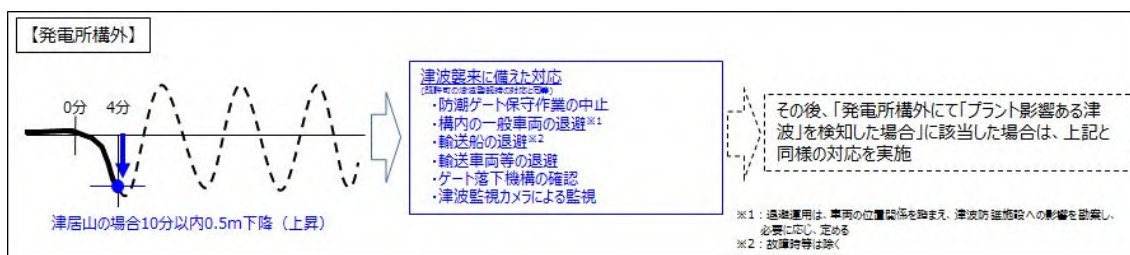
図2 発電所構外にて「プラント影響の可能性のある津波」を検知した場合の対応の概念図
