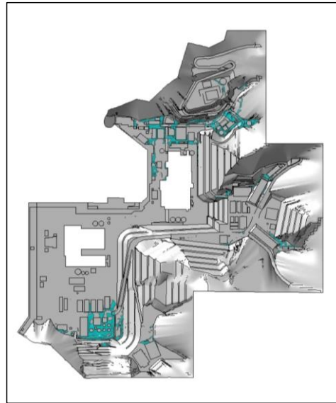
図 10-3-2 屋外タンクの溢水伝播挙動 (1/2)
