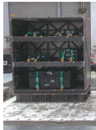
収納箱を保管棚に固縛した状態
