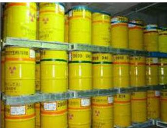
貯蔵室 (A101)<br>(床 T. P. 約+6.2m)<br>ドラム缶 4 本をパレットに乗せ、最大 3 段積<br>みにして貯蔵。                                                       | JIS Z<br>1600 に基<br>づき製作 |
