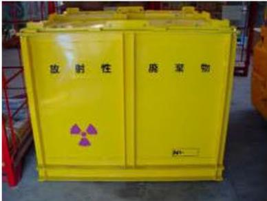
ガスケット<br>(材質: クロロプレングム)<br>※定型容器の他、複数種類の大きさが異なるコンテナが<br>貯蔵されている。 | (定型容器)※<br>寸法: 約 1430×1430×1100 t2.3<br>材質: SS400<br>空重量: 約 380 kg<br>充填後重量 (計算値):<br>約 440kg~約 2790kg |
