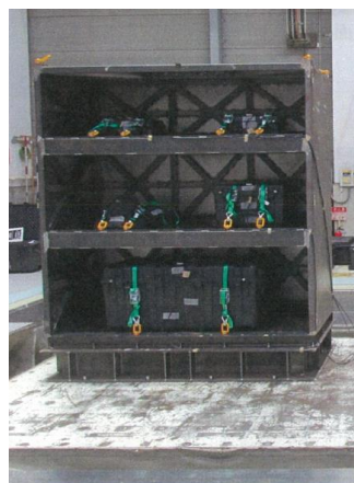
収納箱を保管棚に固縛した状態
